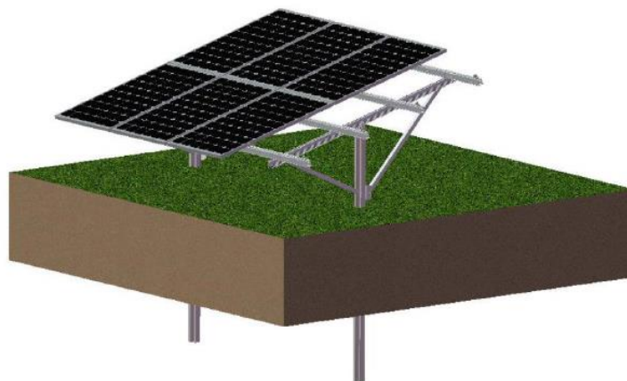
Slika 5. Princip montaže FN modula na tlo
